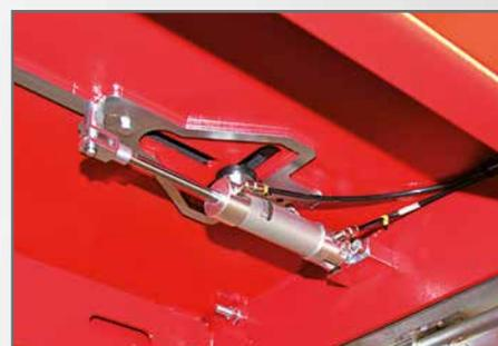
**7. Lift table com duplo cilindro de elevação e duplas extensões** dianteiras e traseiras para maior flexibilidade na captura dos pontos de elevação, não é necessário nenhum movimento do veículo na ponte.
