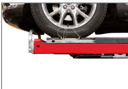
**6. Chemins de roulement oscillants** avec verrouillage pneumatique depuis la centrale.
