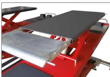
**8. Mécanisme de levage à double levier** pour assurer le parallélisme continu du levage.
